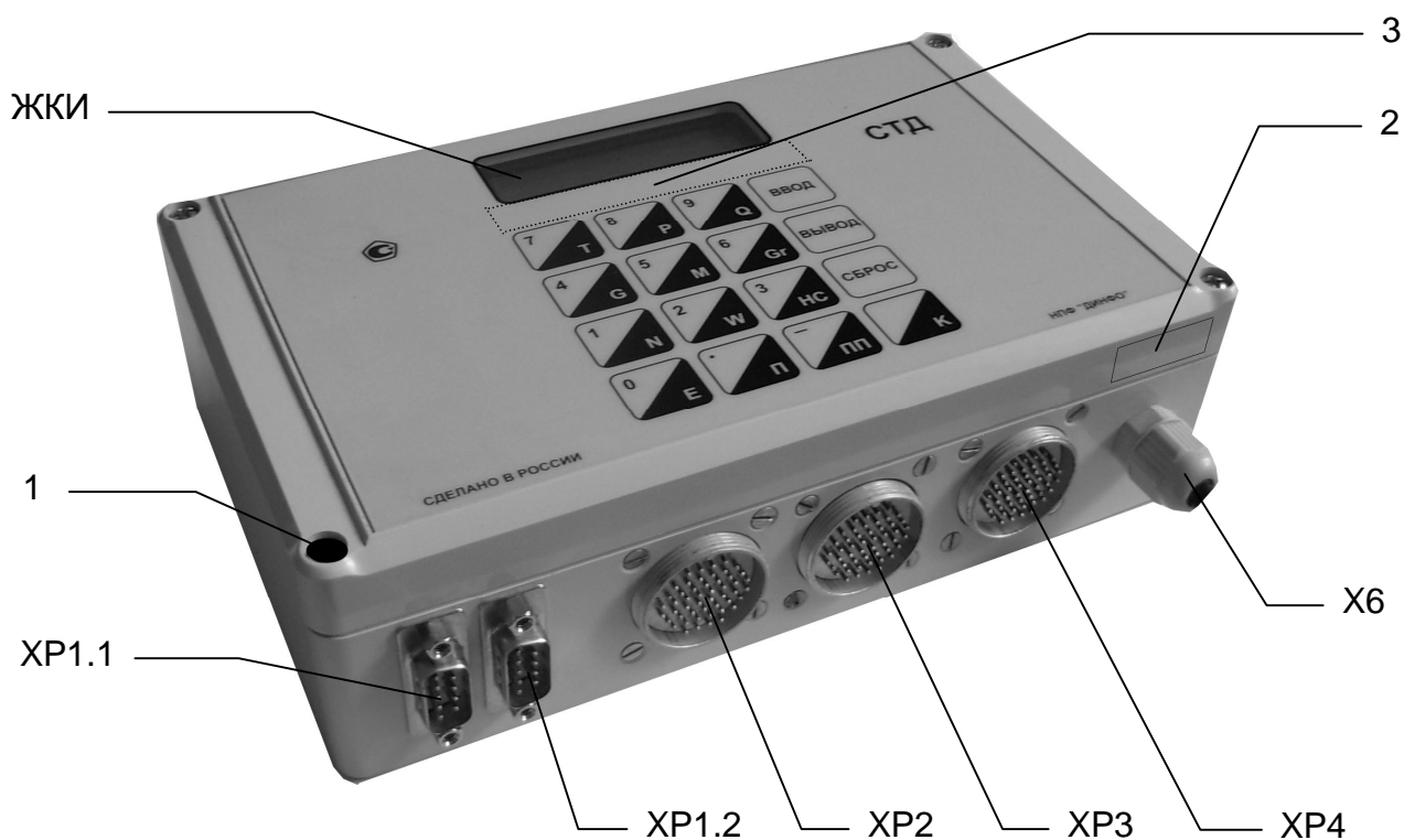
Рисунок 1 – Внешний вид ВТД-У при использовании разъемов D-SUB
